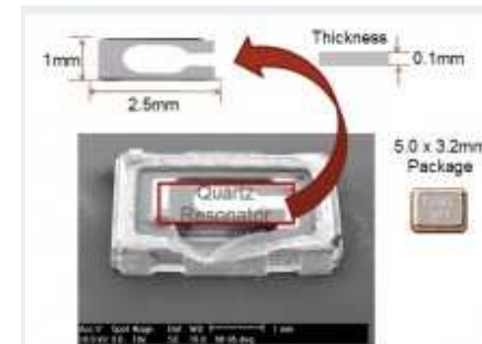
Aufbau eines Quarz-Oszillators. (Bild: Endrich Bauelemente)
