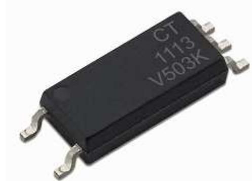
Optokoppler werden u.a. in Schaltnetzteilen eingesetzt, um Signale über die Isolationsbarriere zwischen Primär- und Sekundärseite hinweg zu übertragen. Normen wie die DIN EN 60747-5-5 (VDE0884) Klasse II, UL1577, IEC 60065 oder IEC 60950 verlangen in Schaltnetzteilen aus Sicherheitsgründen einen Abstand von mindestens 8mm zwischen der Eingangsspannung (240V Netzspannung) und dem Niederspannungskreis.
