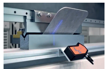
3D-Winkelmessung beim Gesenkpressen
